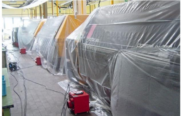
腐食抑制応急処置中の設備
